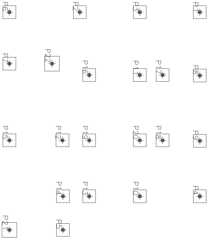
Fundação Formas Concreto: C20, em geral Aços em fundações: CA-50-A e CA-60-B Escala: 1:100
